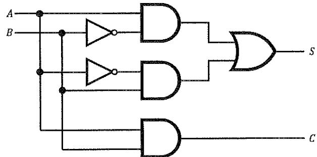
論理回路の設計は、真理値表から初期的な論理式を導出し、可能であれば式を簡単化し、OR 回路、AND 回路、NOT 回路等の基本論理回路（論理ゲート）を用いて回路を構成することにより行われる。上述の半加算器回路の場合、真理値表から求められる論理式は次のようになる。ただし、(51) と (52) は順不同である。
